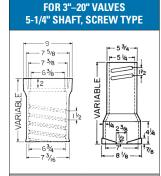
6860 SCREW TYPE VALVE BOX CAST IRON - 3 PC.
